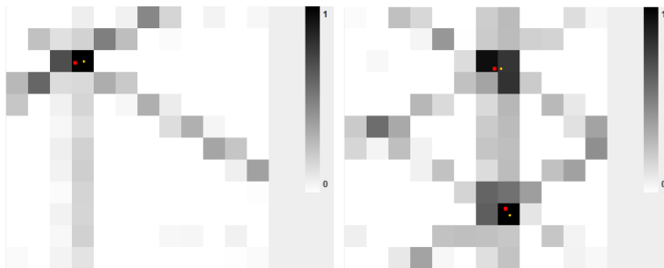
Abbildung 5.5.: Multilayerperzeptron mit binärem Output. Die Detektorstruktur ist hier wieder deutlich zu erkennen, was zu einer schlechteren Auflösung führt. links: ein Hit; rechts: zwei Hits
